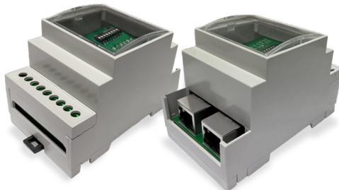
Convertitore di protocollo per interfacciare i visualizzatori delle famiglie EP4\_RS e F4RS con reti a bus di campo Profinet, EthernetIP, EtherCat, Powerlink.
