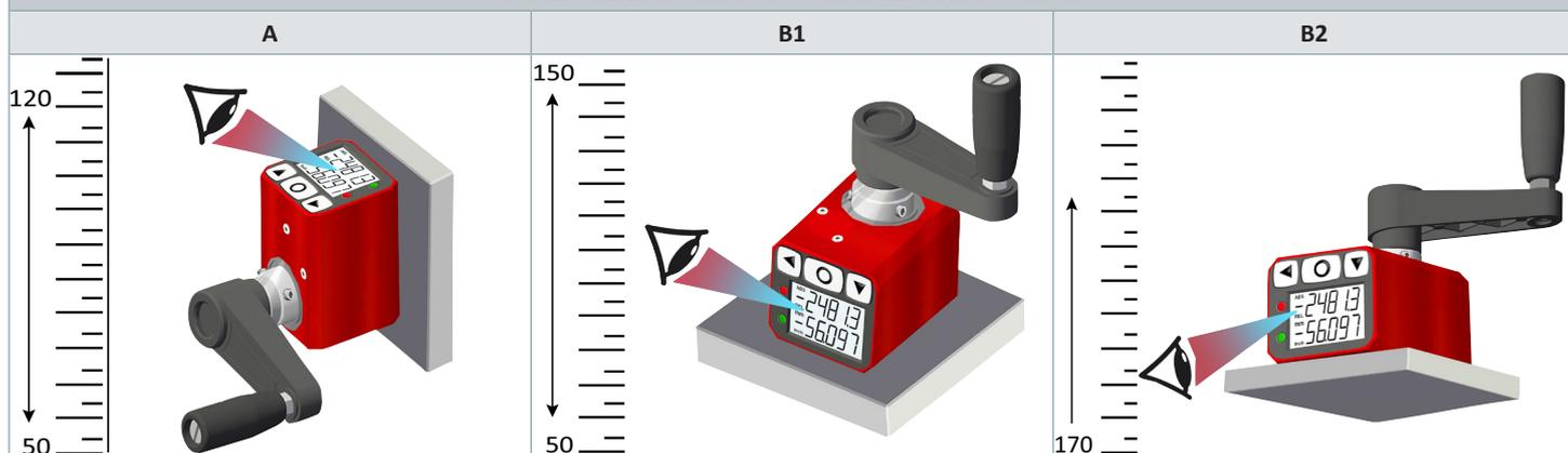
Per una lettura ottimale rispettare l'inclinazione consigliata nelle immagini - *For optimal visibility, orient the unit based on the viewing angle as shown in the images*
