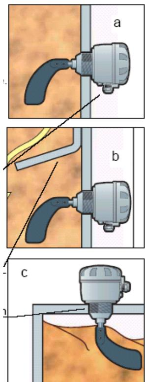
Es ist nötig einen **Abweisungsschutz**, von ca. 8-10 cm, über den Füllstandsprüfer vorzusehen, wenn das Medium Gewicht auf Flügelschraube ansehnlich ist, z.Bei Medien mit hohem spezifischen Gewicht oder mit Massen Bewegungen (b).
